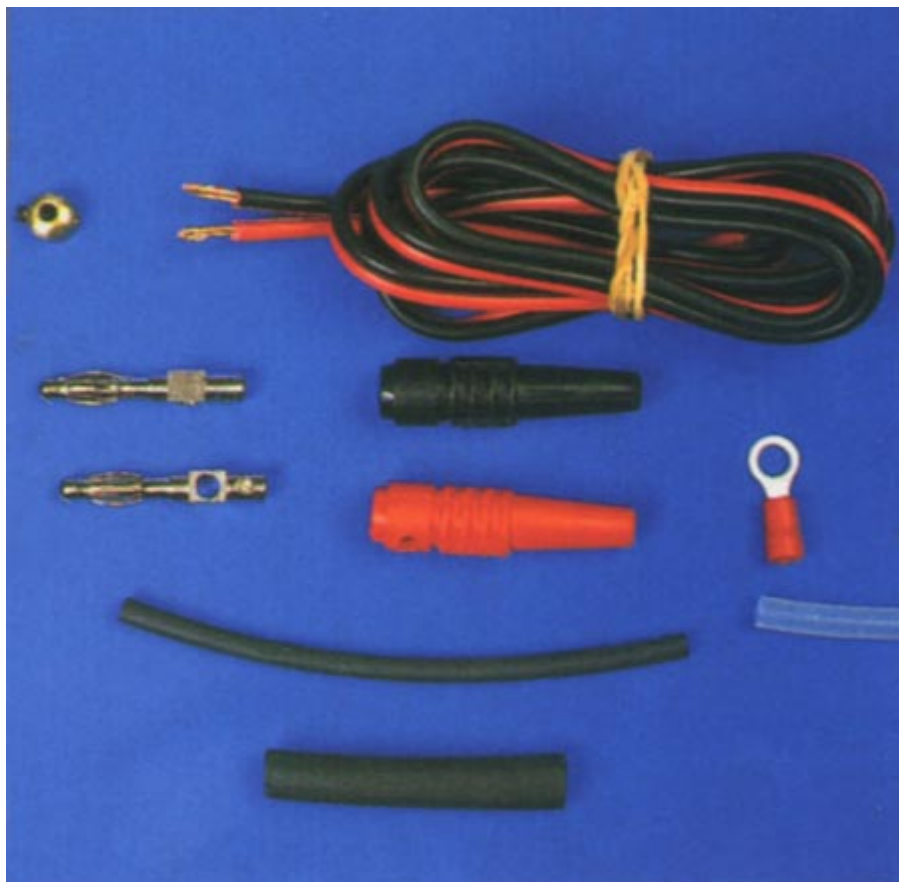
Para instalar el conector: un prisionero de ruedas en latón con orificio de 3 mm., cable timbrado de audio con sección de al menos 1 mm., dos conectores eléctricos de tipo banana, un terminal eléctrico de cabeza redonda, tubo aislante termorretráctil y tubería de silicona.
